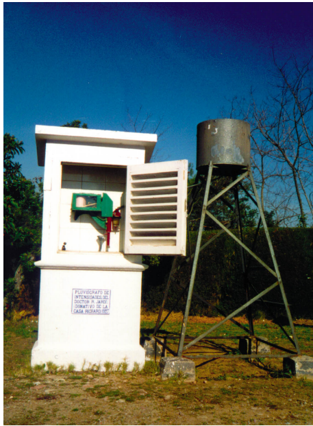
Figura 2: Pluviògraf Jardí (físic i assessor de l'Observatori Fabra), instal·lat a l'Observatori Fabra des de l'any 1927. Amb aquest aparell, encara en funcionament, s'ha enregistrat una de les sèries contínues d'intensitat de precipitació més llargues del món. Aquesta sèrie ha estat utilitzada per a diferents estudis (arxiu de l'Observatori Fabra)
